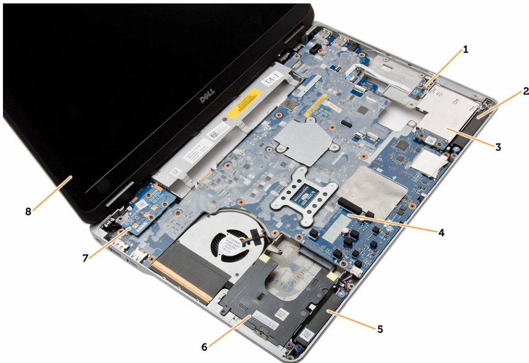
Рисунок 2. Вид сверху (клавиатура и упор для рук в сборе сняты)
